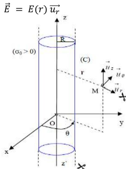
Le système possède une symétrie de **révolution** par rapport à l'axe  $z'$   $z$  et de **translation** parallèlement à cet axe : le champ  $E$  en un point M situé à la distance  $r$  de l'axe est donc de la forme :
