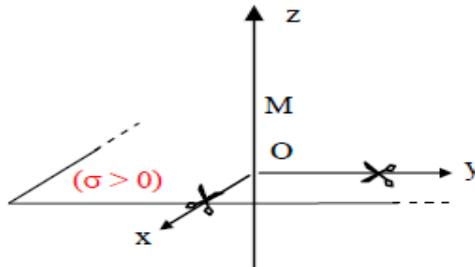
\* Le plan chargé est invariant par translations suivant  $Ox$  et  $Oy$ . Le système des coordonnées le plus adapté au calcul de  $\vec{E}$  est le système cartésien de base  $(\vec{i}, \vec{j}, \vec{k})$ . Le champ  $\vec{E}$  est indépendant de  $x$  et  $y$  :  $\vec{E}(M) = \vec{E}(x, y, z) = \vec{E}(z)$ .
