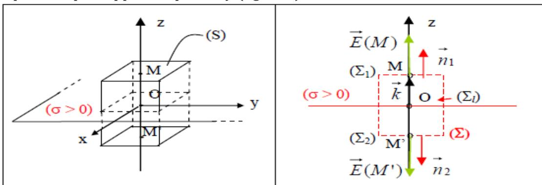
Le flux  $E$  sortant de la surface **latérale**  $\Sigma_l$  du cylindre est **nul**, car en tout point de  $\Sigma_l$ ,  $\vec{E} \cdot d\vec{\Sigma}_l = 0$
