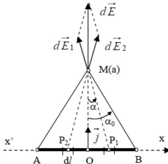
Le champ électrostatique  $\vec{E}$  créé par l'ensemble de la charge portée par le segment AB est donc, par raison de symétrie, dirigé suivant l'axe des y. Soit,
