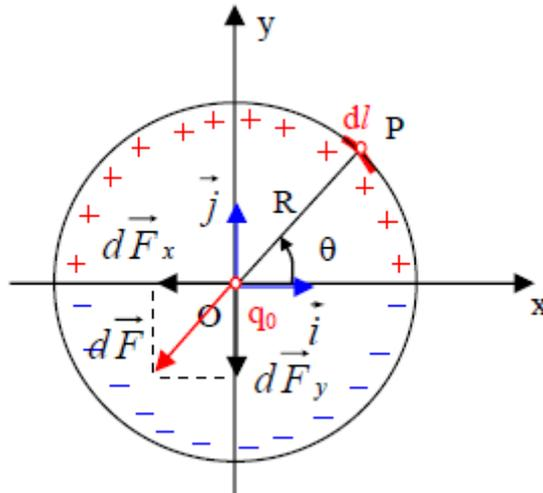
Un élément de charge  $dq = \lambda_0 \sin\theta dl$  (avec  $dl = R d\theta$ ), porté par un élément de longueur  $dl$  centré en un point moyen P, exerce sur la charge  $q_0$  placée en O une force électrostatique élémentaire donnée par :
