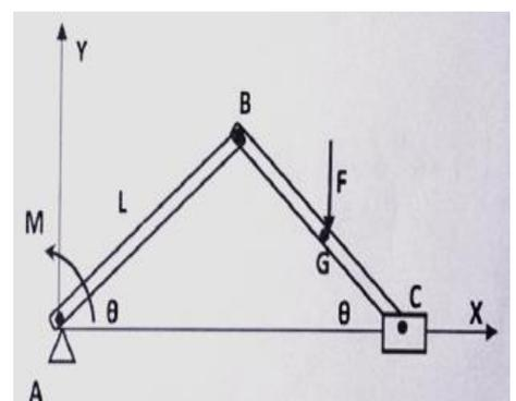
1- Par le principe des travaux virtuels, calculer le moment M à l'équilibre et déduire la force généralisée  $Q_\theta$ .
