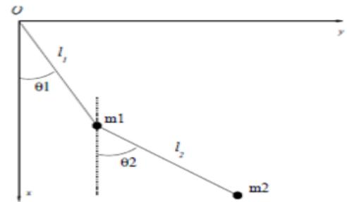
1. Le fil inextensible reliant la masse  $m_1$  à  $O$  développe une tension sur  $m_1$  qui le maintient à une distance constante de  $O$  et donc impose la relation  $x_1^2 + y_1^2 = l_1^2$ , et donc la liaison est une liaison holonome,  $(x_1, y_1)$  étant les coordonnées de  $m_1$  dans le plan  $(Oxy)$ . De même le fil inextensible liant  $m_1$  à  $m_2$  et les maintenant à une distance constante impose  $(x_1 - x_2)^2 + (y_1 - y_2)^2 = l_2^2$  et donc la liaison est holonome également.
