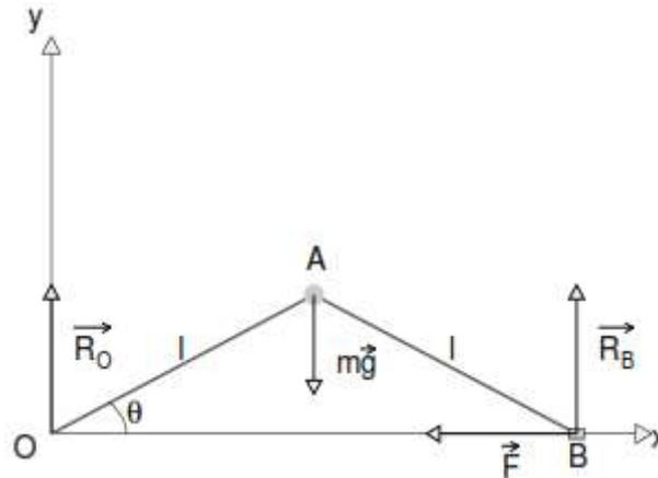
Figure 1 - Système de treillis.
