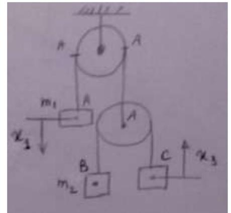
1- Les forces généralisées  $Q_{x_1}$  et  $Q_{x_3}$   $q_1 = x_1$  et  $q_3 = x_3$
