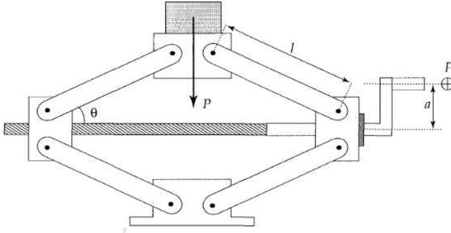
*Figure : Principe du cric.*
