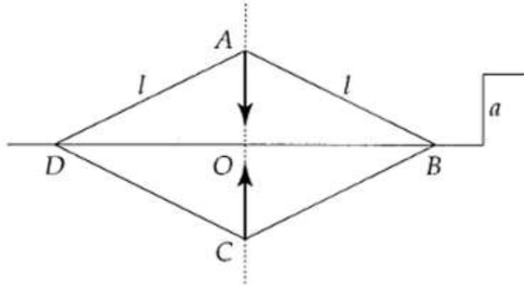
Figure : Losange ABCD représentant le cric de façon schématique
